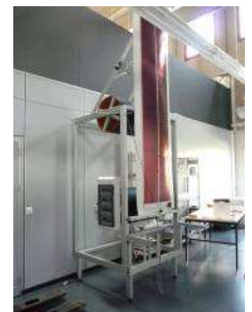
Mechanische Prüfung von flexiblen Solarmodulen
