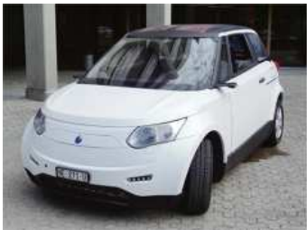
Vom PSI zusammen mit der Belenos Clean Power Holding realisiertes Brennstoffzellenfahrzeug
