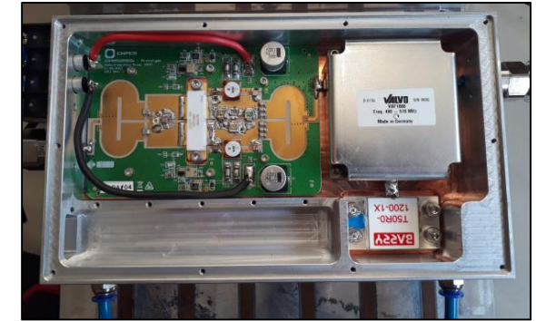
800W 500MHz amplifier module
