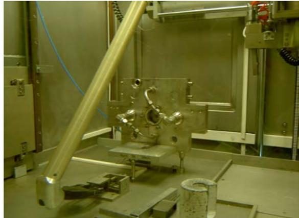
Den Targethalter mit Plastiksack einpacken, aus der Hotzelle nehmen und in die vorbereitete, mit Plastik ausgelegte, Kapelle transportieren.
