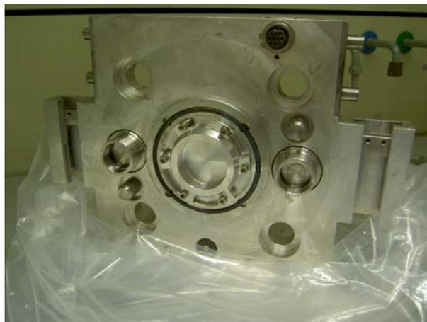
Neues Targetfenster mit einer Helikoflex-Dichtung anbringen.
