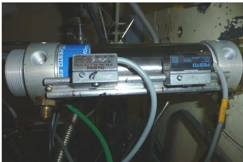
Druckluftanschlüsse und Endschalter für „verriegelt“ und „entriegelt“ demontieren damit der Zylinder rausgedreht werden kann.
