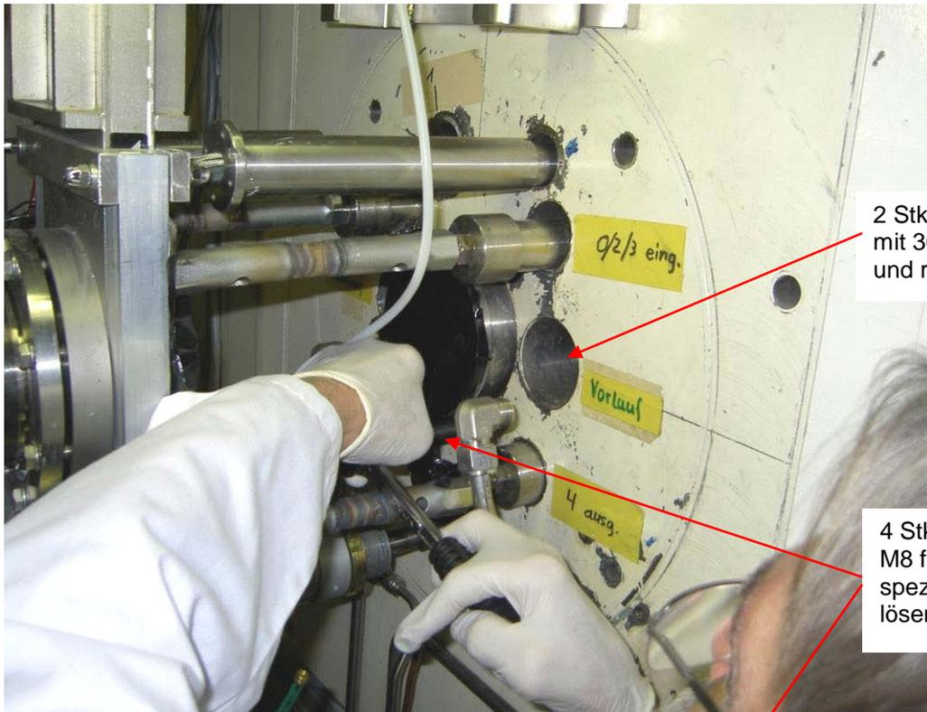
2 Stk Wasserkupplungen mit 30 mm Nuss lösen und rausnehmen
