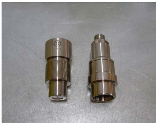
Wasserkupplung Targetstation - Targetflansch
