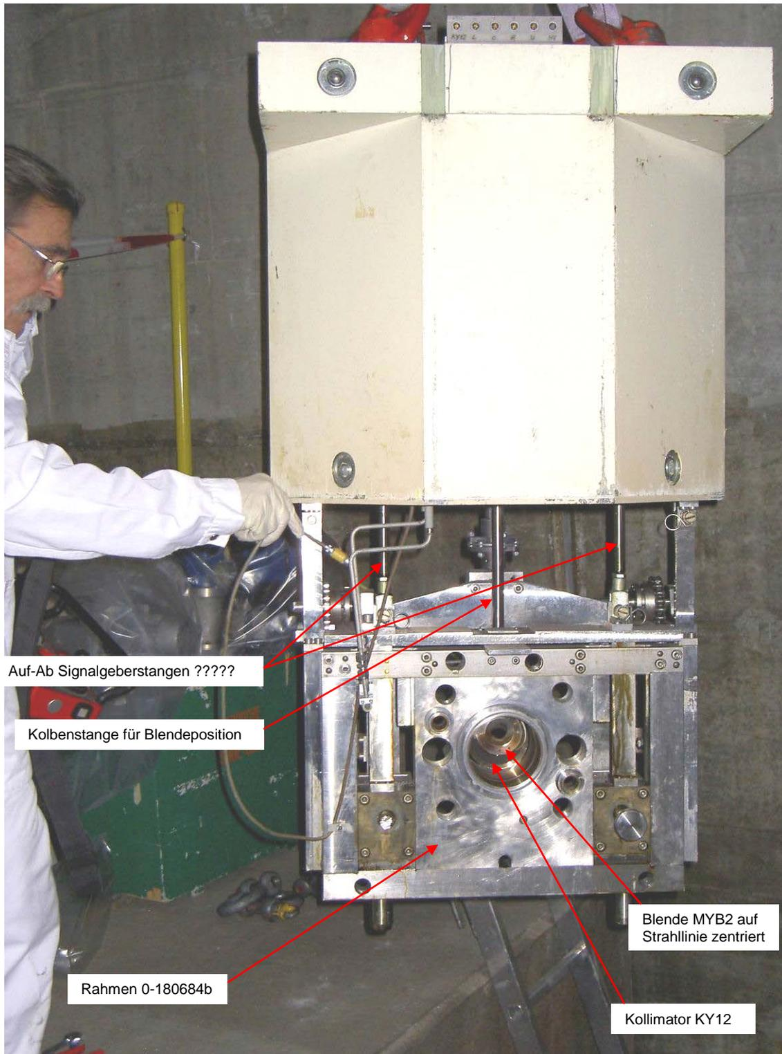
Sicht von der Targethalterseite auf ausgebaute Targetstation
