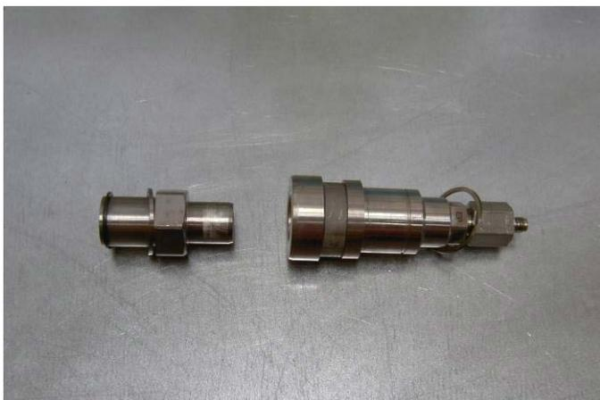
Gaskupplung Targetstation - Targetflansch
