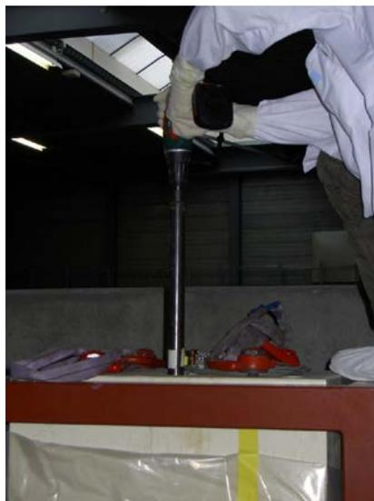
Andockspindeln mit Hilfe der Handbohrmaschine und dem Montagerohr durch die Abschirmung manuell bewegen, so sind nur noch Positionen anfahren möglich.
