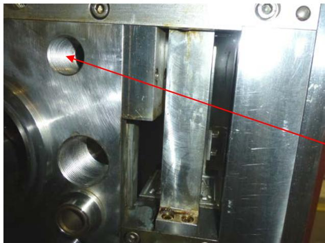
Mit Drahtbürste und Bohrmaschine
