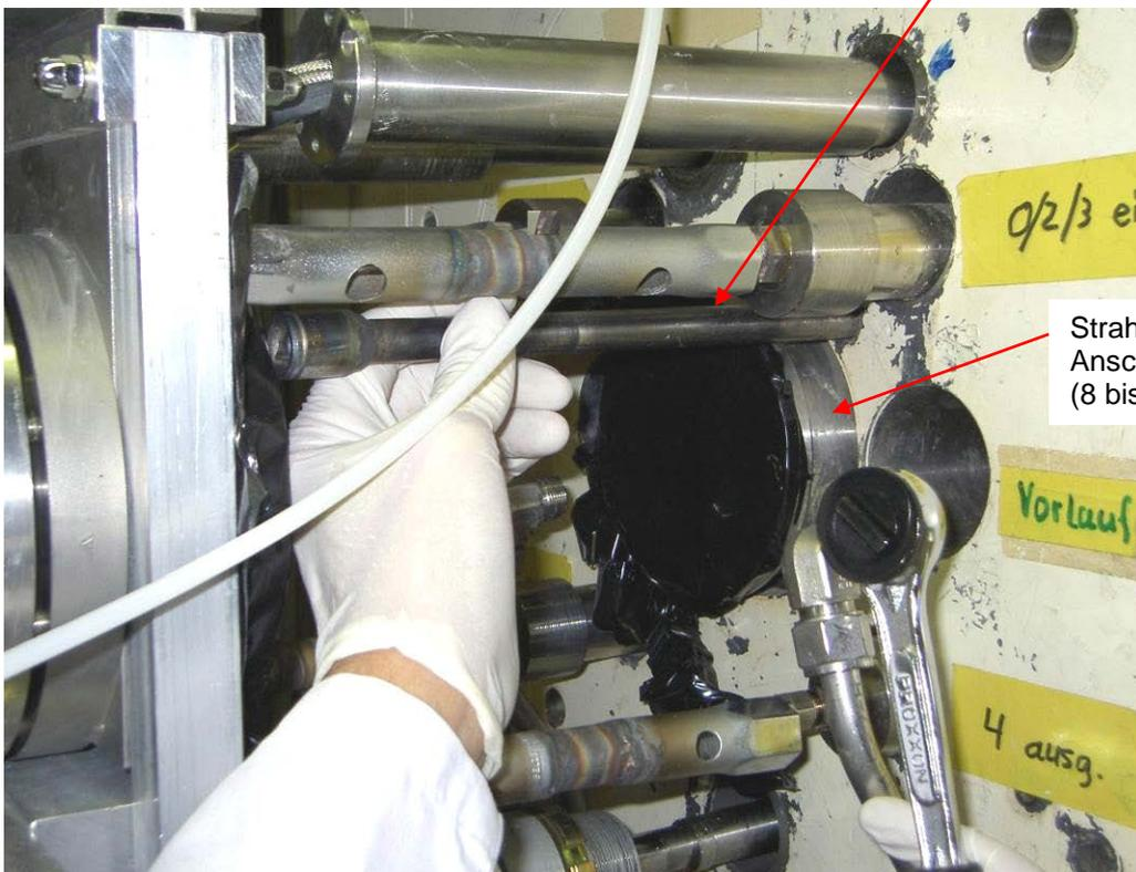
Strahlrohr bis zum Anschlag rausziehen (8 bis 10 mm)
