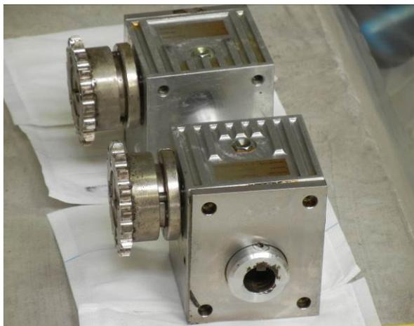
Spindelhubgetriebe mit Zahnrad (Kettenantrieb)
