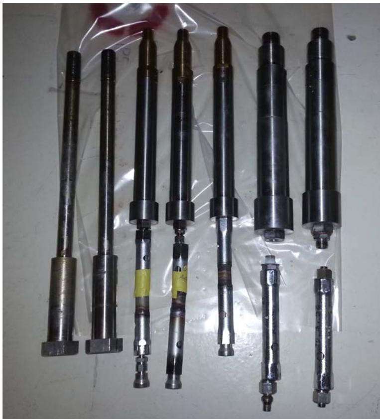
Wenn möglich Komponenten (ausser Elektrodurchführungen) ganz ausbauen damit die Gewinde mit Bürste gereinigt und anschliessend gefettet werden können.
