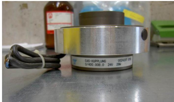
EI.Magnetkupplung für Auf-Ab Hubspindeltrieb
