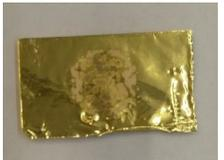
592 µg/cm<sup>2</sup> Th-232 on 20 µm Au foil
