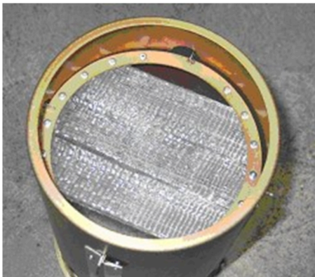
Längsdraht (Kettfaden) 0.3mm Querdraht (Schussfaden) 0.1mm
